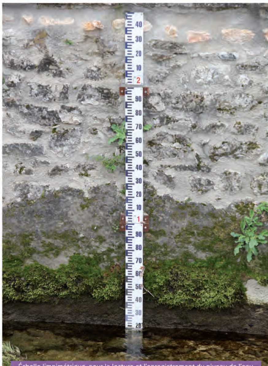
Échelle limnimétrique, pour la lecture et l'enregistrement du niveau de l'eau
