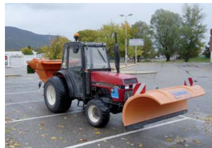
▲ Le tracteur équipé du nouveau système d'épandage du sel et de déneigement
